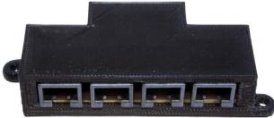
Eingang: 1 x RJ45 | Ausgang: 4 x RJ45
