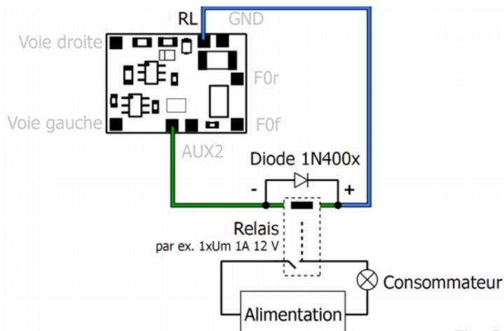
Fig. 2 : commande d'un accessoire au travers d'un relais
