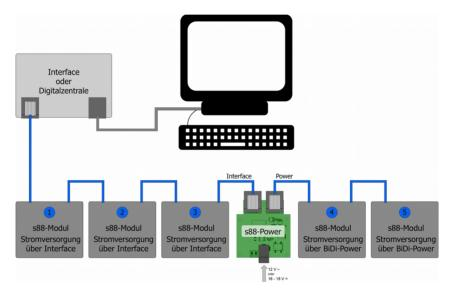
Im Beispiel werden die s88-Module 1 bis 3 über die Busleitung von der Digitalzentrale / vom Interface versorgt. Der Strom, den die Zentrale / das Interface für den s88-Bus bereitstellen kann, reicht nicht für die Versorgung weiterer s88-Module. Daher ist ein s88-Power in die Busleitung eingefügt. Dieses liefert 700 mA Strom für die Versorgung weiterer s88-Module (hier s88-Module 4 und 5).
