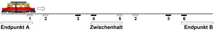
Der Triebwagen fährt an Endpunkt A los und überquert die Kontakte 1 und 2 ohne Beeinflussung. Am Kontakt 3 bremst das Fahrzeug auf eine langsamere Geschwindigkeit ab und wird dann am Kontakt 4 zum Stillstand gebremst. Nach der Wartezeit beschleunigt der Triebwagen wieder und lässt die Kontakte 5 und 2 ohne Reaktion hinter sich. Vor dem Endpunkt B bewirkt Kontakt 3 das Abbremsen auf die langsamere Geschwindigkeit und Kontakt 6 veranlasst die Reduzierung der Geschwindigkeit bis zum Stillstand.
