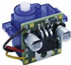
Exemple d'application : servo 9 g, avec la surface latérale fixée à la face inférieure de la carte du servo.
