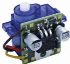
Anwendungsbeispiel: 9 g-Servo, mit der Seitenfläche auf der Unterseite der Servoplatine befestigt
