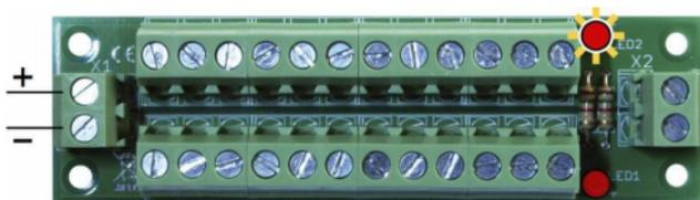
Bei Anschluss an eine Wechselspannungsquelle leuchten beide LEDs.
