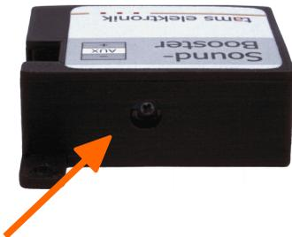
Auf der Rückseite hat das Gehäuse des Sound-Boosters ein Loch, hinter dem sich das Trimpoti zur Einstellung der Lautstärke befindet. Verwenden Sie zur Lautstärke-Einstellung einen kleinen Schraubendreher.
