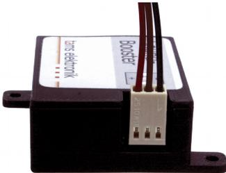
Stecken Sie die Buchsenleiste auf die Stiftleiste des Sound-Boosters und stellen Sie die Verbindungen zum Steuermodul (Servosteuerung SD-32 oder LC-NG-Modul) entsprechend dem Anschlussplan und der Tabelle her.
