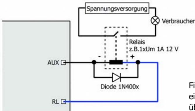
Fig. 3: Anschluss eines Verbrauchers über ein Relais
