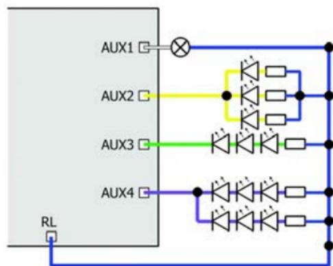
Fig. 2: Beispiele für Anschluss von Verbrauchern und LEDs an die Funktionsausgänge
