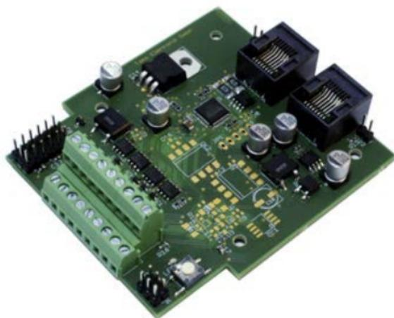
Décodeur pour servomoteurs octuple
