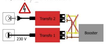
Connexion en parallèle des transformateurs : Danger de mort par électrocution !
