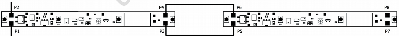
Fig. 3: Durchschleifen der Stromversorgung | Parallel operation from one power supply Alimentation commune à plusieurs platines | Doorvoeren van de stroomtoevoer
