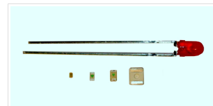
oben: bedrahtete LED 3 mm unten (von links nach rechts): SMD-Bauformen 0402, 0603, 0805, PLCC2
