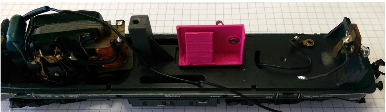
Bild 4: angeschraubte Decoder Halterung
