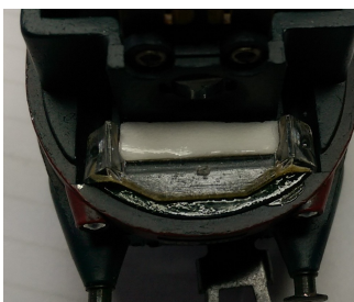
Bild 19: Klebeband zwischen den Lichtleitern.
