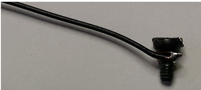
Bild 6: Behelfs-Lötöse, Draht um Schraube gewickelt und verlötet
