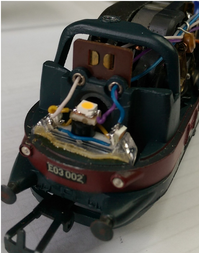
Bild 25: LEDs auf der Rückseite. Sehr schön zu sehen ist auch die Kabelführung (auch oben rechts am Motor).
