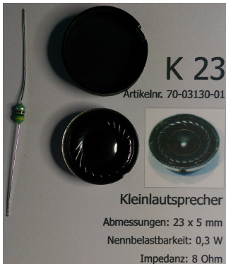
Bild 12: Der Lautsprecher K23 mit Schallkapsel und die Drossel, die dem Decoder bei lag.
