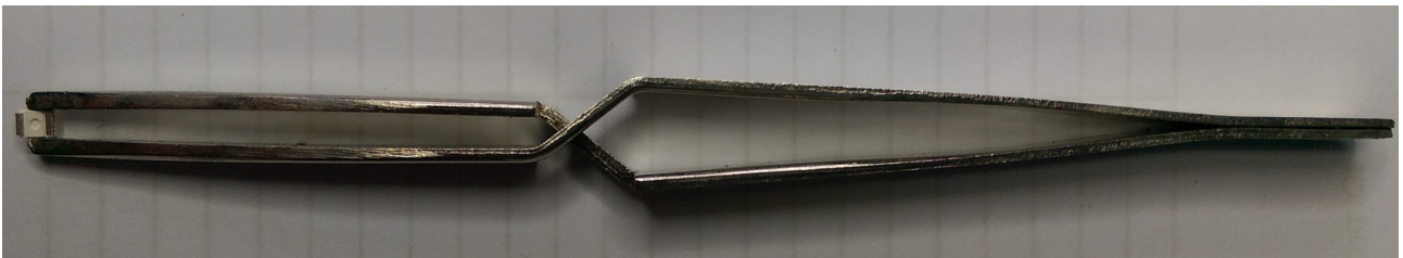
Bild 17: selbst haltende Pinzette mit eingeklemmter PLCC2-LED.
